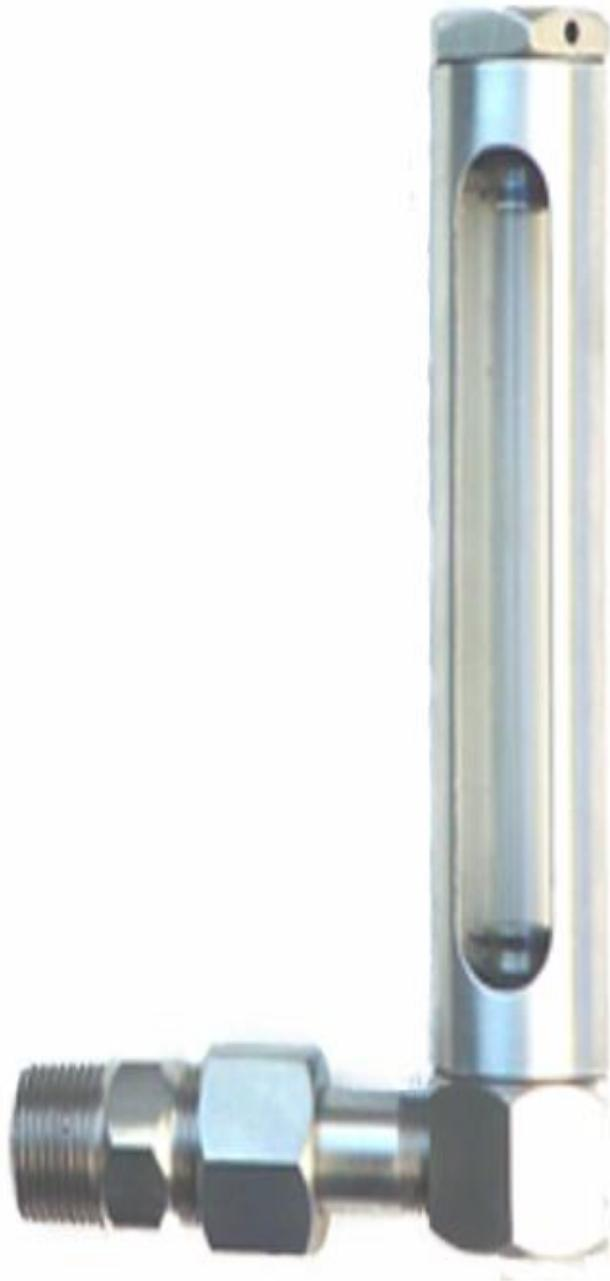
Permite observar el nivel de liquido contenido en un tanque o reservorio de un equipo . El tubo visor cilíndrico es de Vidrio borosilicato del tipo Pyrex , el tubo visor está protegido contra golpes o accidentes , por una carcasa metálica. Excelente grado de resistencia a la corrosividad , condiciones de carga térmica y químicas adicionales.
