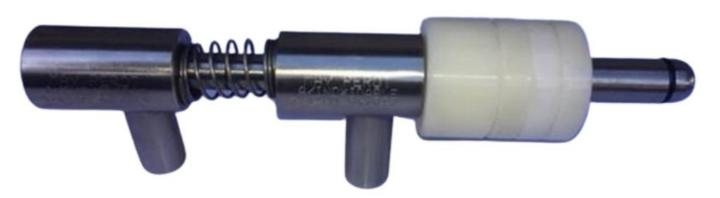
Picos para Llenadora a Presión Fabricados en Material de Acero Inoxidable Calidad 316, lo cual le da una calidad Sanitaria y puede ser utilizado con confianza para productos en el Aérea Alimenticia. Son para productos Líquidos, Poseen también Oring en material de Viton, Los separadores son fabricados en Nailon, el resorte es en Acero Inoxidable, Goma de Ultraleno con la dureza ideal para ser el sellado perfecto al momento de hacer el retorno del producto.
