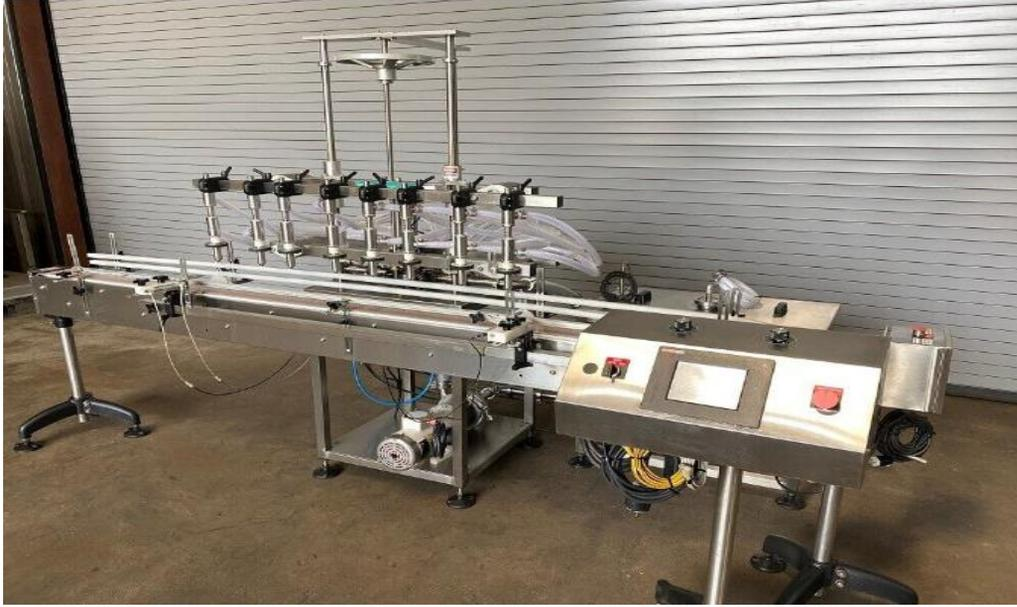
Fabricación en Acero Inoxidable SS-316, grado alimenticio ; y en Plástico PVC altamente resistente a fluido muy corrosivos (Cloro, Acidos , etc).
