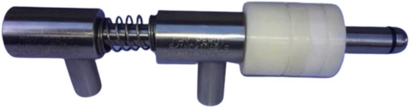
Picos para Llenadora a Presión Fabricados en Material de Acero Inoxidable Calidad 316, lo cual le da una calidad Sanitaria y puede ser utilizado con confianza para productos en el Área Alimenticia. Son para productos Líquidos, Poseen también Oring en material de Viton, Los separadores son fabricados en Nailon, el resorte es en Acero Inoxidable, Goma de Ultraleno con la dureza ideal para ser el sellado perfecto al momento de hacer el retorno del producto.
