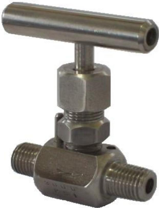
Construidas totalmente en Acero Inoxidable calidad 316. con eje de punta cónica, en Acero inoxidable AISI 316. Estas válvulas están diseñada para el uso general y cuando se requiere un cierre hermético repetitivo de seguridad, fácil mantenimiento y larga vida útil de servicio confiable. Estas válvulas son utilizadas en plantas de GPL y gas natural. Usos instalación de Manómetros Tomas de Presión, etc. Presión /Temp.. Operación . : 6000 PSI a 250 C
