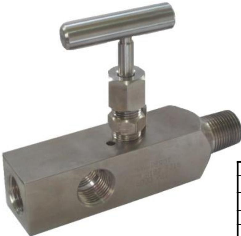
La Válvula Multiport reduce el numero de componentes de salida requeridos para la instalación de Instrumentos Permiten instalación de manómetros, switches de presión, y trasmisores de presión en cualesquiera de los orificios roscados de la válvula. Fabricación en acero inoxidable 316.
