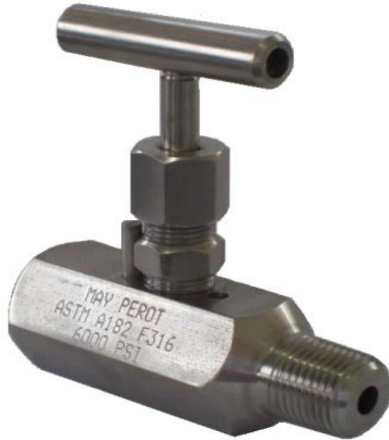
Construidas totalmente en Acero Inoxidable calidad 316. con eje de punta cónica, en Acero inoxidable AISI 316. Estas válvulas están diseñada para el uso general y cuando se requiere un cierre hermético repetitivo de seguridad, fácil mantenimiento y larga vida útil de servicio confiable. Estas válvulas son utilizadas en plantas de GPL y gas natural. Usos instalación de Manómetros Tomas de Presión, etc. Presión /Temp. Operación.: 6000 PSI a 250 C
