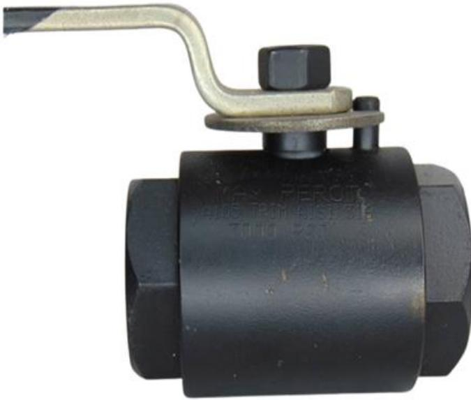
Fabricadas el cuerpo en acero al carbono ASTM A 105 ; y las partes internas Trim (bola , eje) en Acero Inoxidable 316 . Sellos en Teflón.
