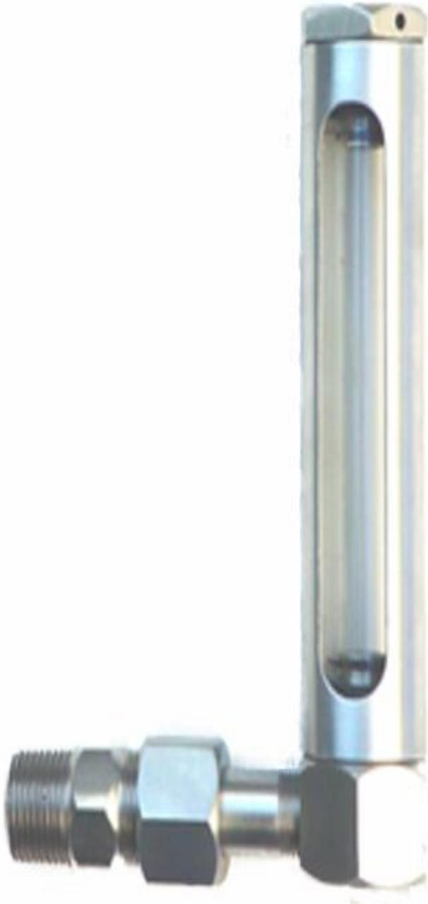
Permite observar el nivel de líquido contenido en un tanque o reservorio de un equipo . El tubo visor cilíndrico es de Vidrio borosilicato del tipo Pyrex , el tubo visor está protegido contra golpes o accidentes , por una carcasa metálica. Excelente grado de resistencia a la corrosividad , condiciones de carga térmica y químicas adicionales.
